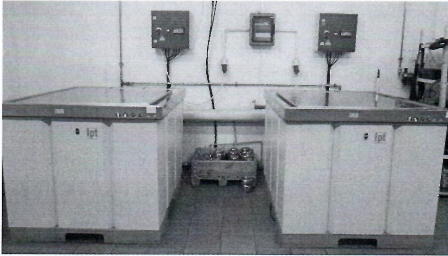
Slika 2. Instalacija za ispitivanje na unutrašnji statički pritisak (komore sa displejima i pogonskim sistemom)
